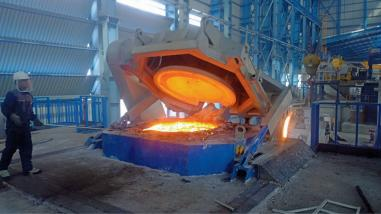
FASTETST FURNACE DISCHARGE TO MINIMIZE HEAT LOSSES
